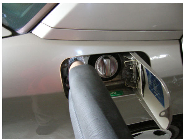
Abb. 4 - Über isolierte Vorlauf-/Rücklaufleitungen und eine Wärmeübergabestation wird der Wärmespeicher entladen.
