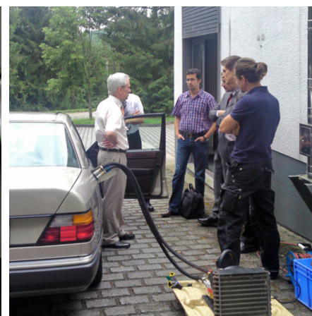
Abb. 4 - Über isolierte Vorlauf-/Rücklaufleitungen und eine Wärmeübergabestation wird der Wärmespeicher entladen.
